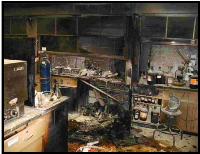
انبار کردن مواد شیمیایی در زیر هود روشی نادرست برای نگهداری مواد است که باعث انفجار شده است
